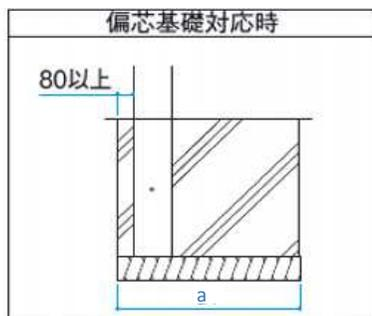
$a = \text{独立基礎寸法(姿図CADデータ参照)} + 400\text{mm}$
